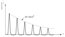
Если уставка I> выбрана равной или больше номинального тока трансформатора, то инверсная кривая терминала VIP будет отстроена от влияний броска тока намагничивания.
