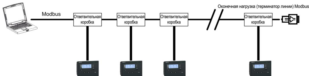
В тех случаях, когда реле защиты VIP410 используется с модулями SC100 (для управления оборудованием среднего напряжения и мониторинга его параметров), шлейфовые соединения образуются непосредственно этими модулями с помощью 3 имеющихся разъемов RJ45 (тройники Modbus).
